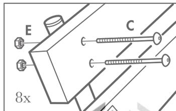
Montera alla skruvar löst tills alla är på plats, spänn därefter alla.
